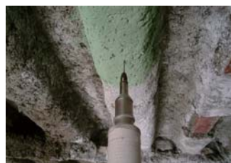
6年後の釘貫入力 3kg (一軸圧縮強度換算6.2kg/cm 2 ) 施工時釘貫入力 900g
